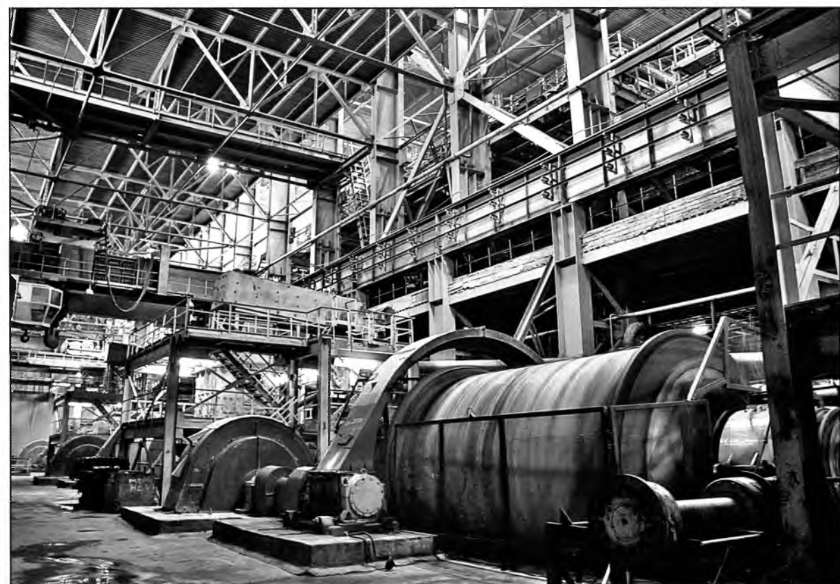
На мельницах АБОФ происходит измельчение и подготовка сырья к переработке
