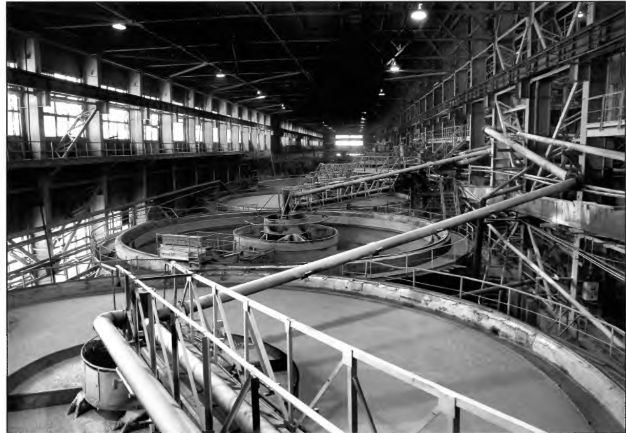
Сушители апатитового концентрата корпуса АБОФ, 18 метров в диаметре
